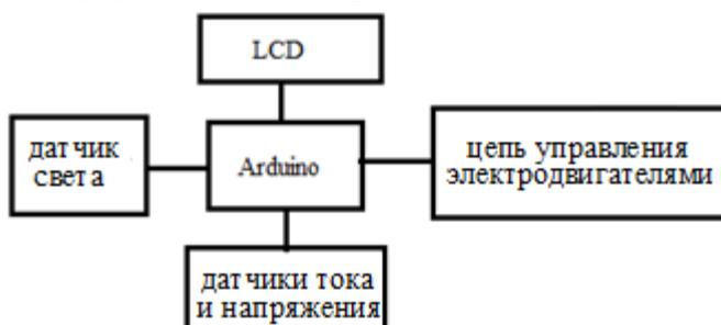
Рис. 1. Блок-схема контроллера
