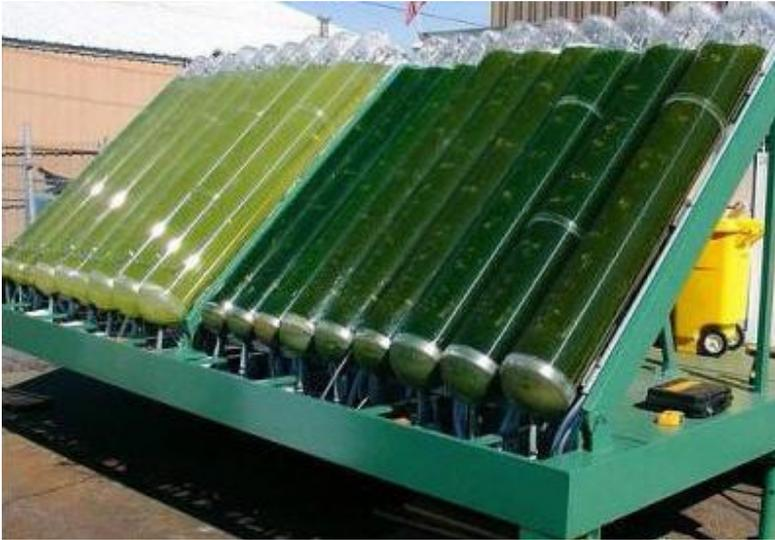
**Рис. 9.** Установки на крыше здания для выращивания хлореллы
